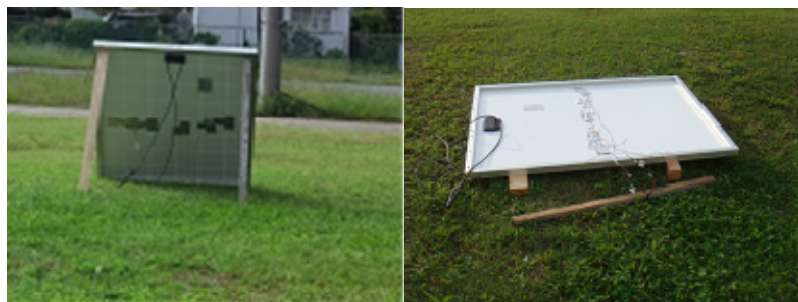
図 B.2.3-8 PV モジュールへの熱電対取り付け状況
