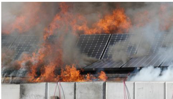
図 B4.1-7 実規模アレイによる燃焼実験
