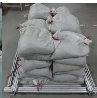
図 3.2.1-4 砂袋による終局耐力試験
