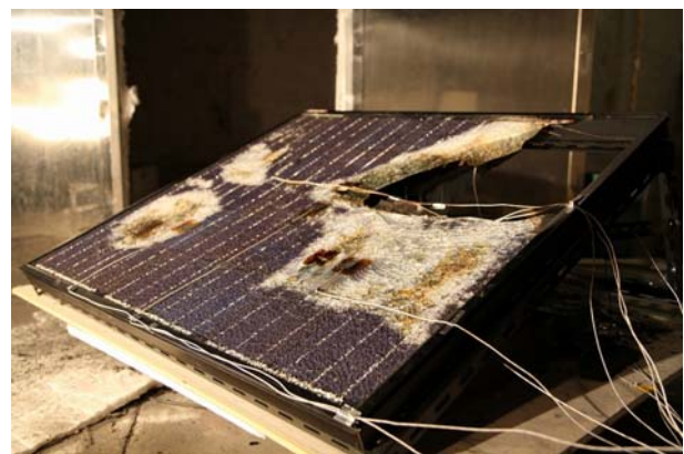
図 13 モジュールの部分脱落の状況
