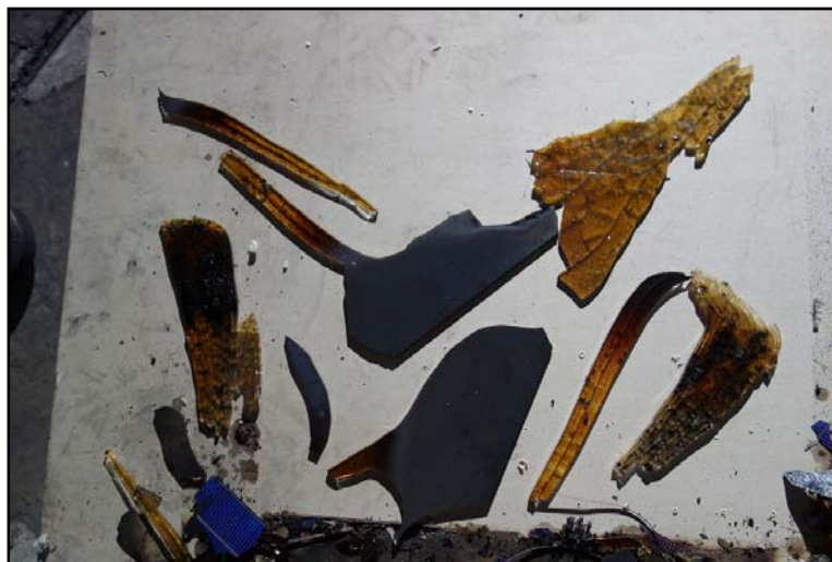
図 14 モジュールから脱落したガラス片
