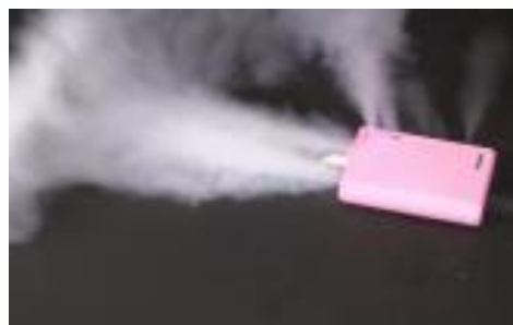
白煙発生（可燃性ガスも発生）
